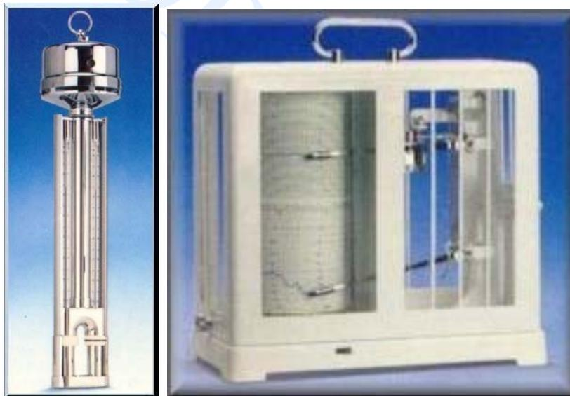
Otro instrumento para medir la humedad relativa se llama *higrómetro de cabello*, que se muestra en la figura 5.7 a la derecha, que mide la humedad relativa directamente. Su operación se basa en que el cabello humano cambia su longitud con los cambios de humedad relativa, el pelo se alarga (acorta) si la humedad relativa aumenta (disminuye). Para medir la
